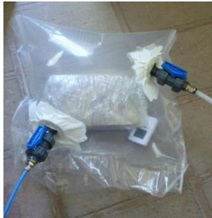
Şekil 14: Azot jeneratörü ve azot gazıyla gerçekleştirilen modifiye atmosfer uygulaması
